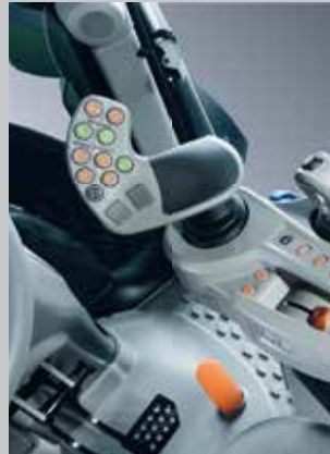
RCshift. De nieuwe, volautomatische Powershift-transmissie voor meer schakelcomfort.
