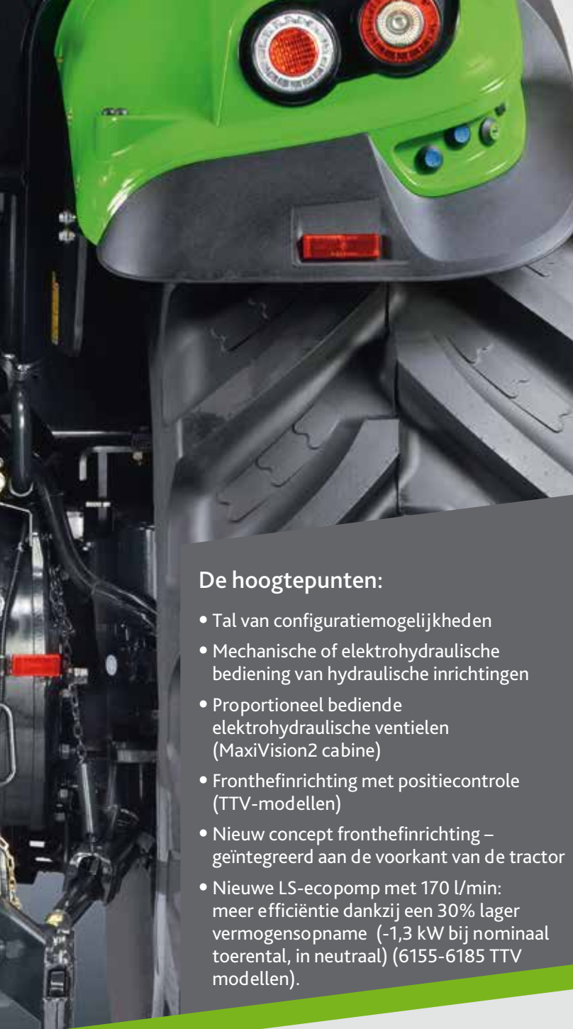
Nieuwe positieregeling van de fronthefinrichting (TTV-modellen) met max. hefvermogen van 5.480 kg.
