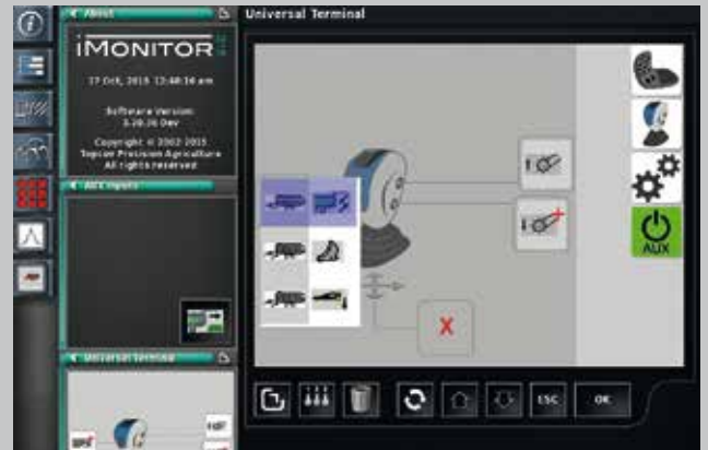
ISOBUS-integratie. Werktuigfuncties aangestuurd door bepaalde tractortoetsen.
