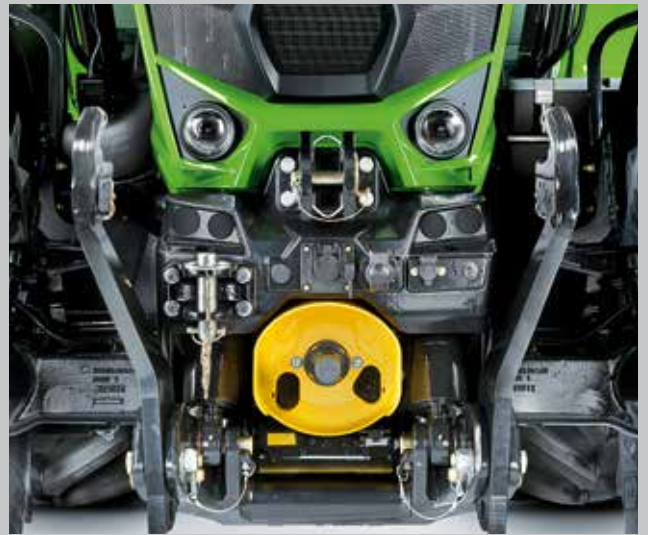
Nieuwe positieregeling van de fronthefinrichting (TTV-modellen) met max. hefvermogen van 5.480 kg.
