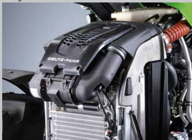
Luchtfilter met PowerCore-technologie: 20% meer luchtstroom dan bij vergelijkbare standaardfilters.
