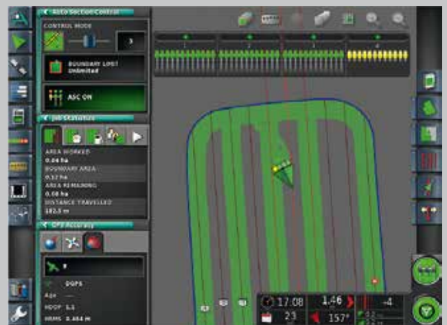
Sectieregeling en aansturing met variabele opbrengst zijn optioneel leverbaar.
