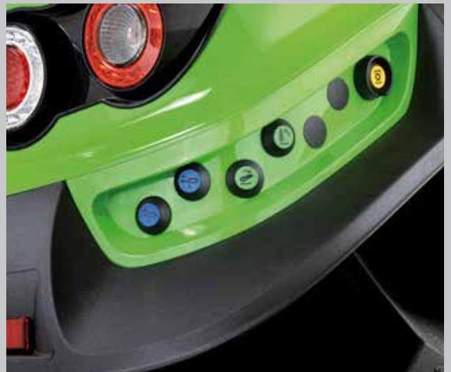
Externe, hydraulische achterhef en PTO-as eenvoudig aan beide kanten te bedienen.
