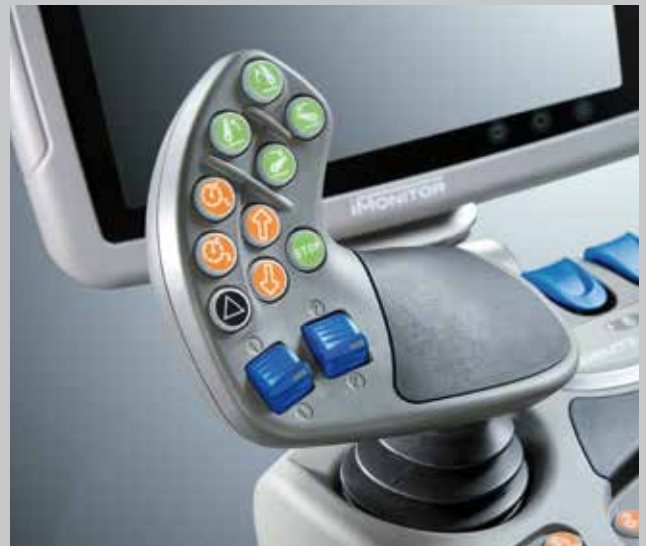
Met een druk op beide knoppen van de multifunctionele MaxCom-hendel kan de bestuurder vier snelheidsinstellingen oproepen, of hij nu op het veld rijdt of op de weg, en op die manier een constante snelheid aanhouden voor optimale resultaten.
