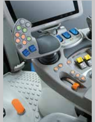
RCshift. De nieuwe, volautomatische Powershift-transmissie voor meer schakelcomfort.
