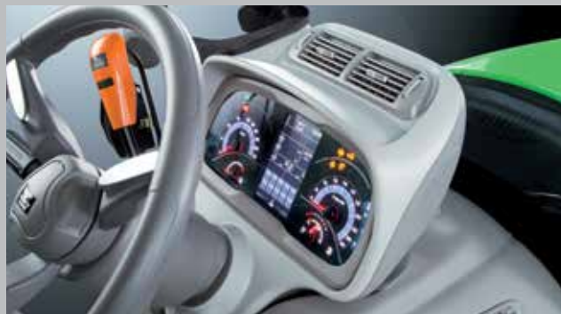
Een zeer geavanceerde dashboard met het nieuw InfoCenter: 5" LCD- kleurendisplay met hoge resolutie, een concept voor klantgerichte topinformatie.
