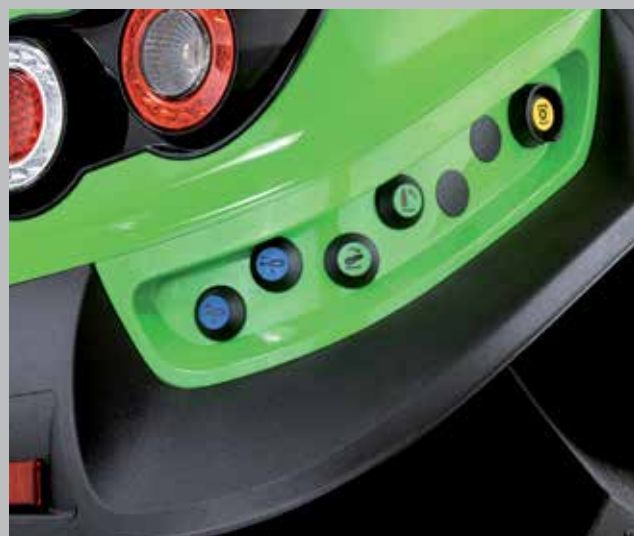
Externe bediening van hefinrichting achter, hulpventiel en aftakas aan twee zijden.
