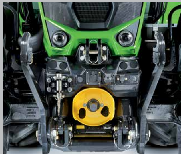
Nieuwe fronthefinrichting met positieregeling, voor nog meer hefvermogen (alleen TTV-modellen).
