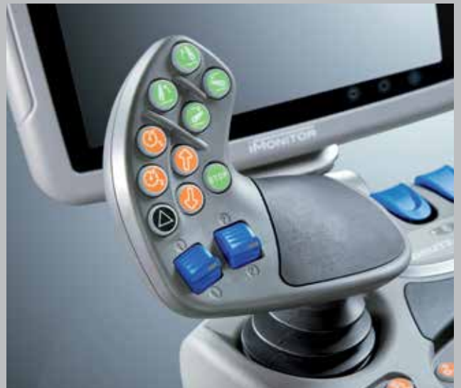
Met een toprijnsnelheid van 50 km/u (waar toegestaan) is de nieuwe 6 Serie TTV ook een echte kei in transport. Met een druk op beide knoppen van de joystick kan de bestuurder alle 4 de snelheidsinstellingen oproepen, of hij nu op het veld rijdt of op de weg, en op die manier een constante snelheid aanhouden voor optimale resultaten.
