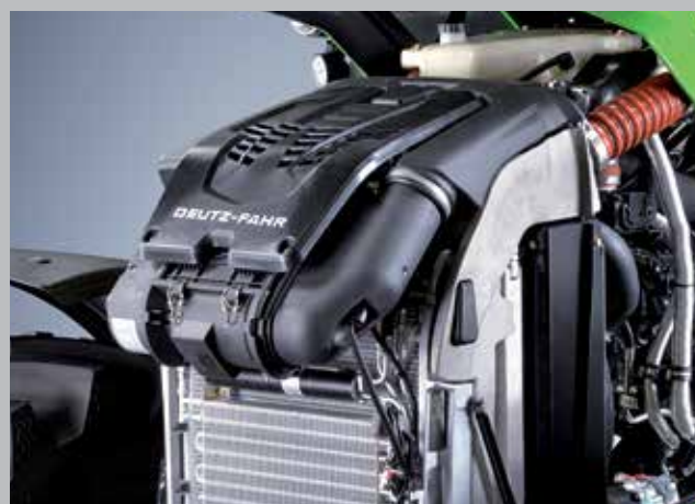
PowerCore-technologie voor luchtfilter: 20% meer luchtstroom dan bij vergelijkbare standaardfilters.
