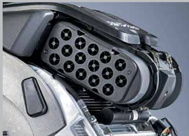
Voorreinigingssysteem van inlaatluchtfilter: spiraalbuizen en aanzuigleiding zuigen 95% van het stof af voordat dit het primaire filter binnengaat.
