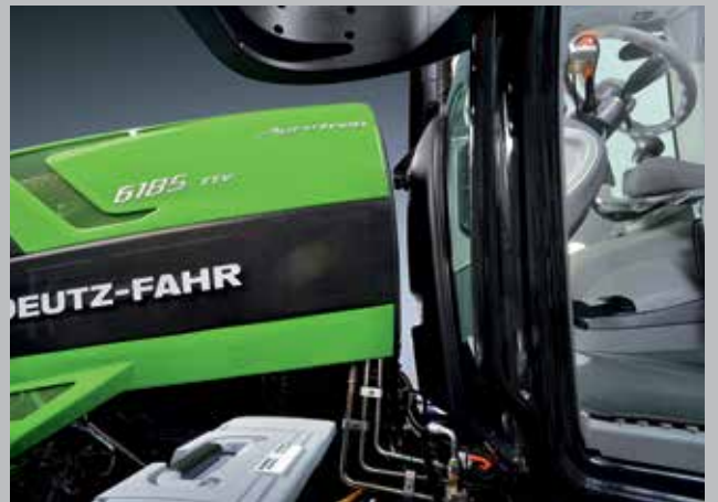
Cabine losgekoppeld van de motorruimte, voor meer rijcomfort.
