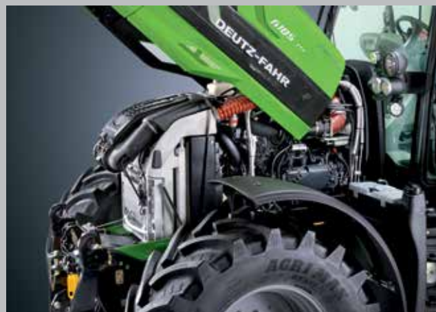
Doeltreffend en compact koelsysteem met warmtewisselaar, motorradiator, transmissie-oliekoeler, brandstofkoeler en condensor.
