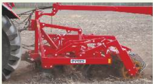
"Tinker": intensieve bewerking door dubbele rij tanden achter
