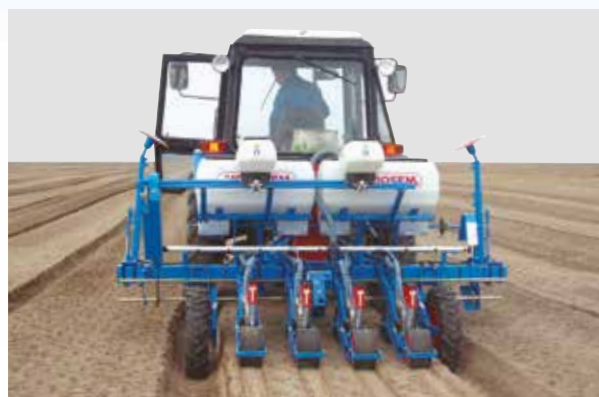
MS-A zaaier Monoblock vast frame 4 rijen met kunstmestopbouw en Microsem
