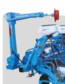
Hydraulisch opklapbare markeur met schijf voor het opklapbare frame (verschillende modellen, afhankelijk van het frame)
