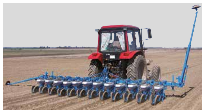
12 rij vast frame monobar MECA V4 zaaier
