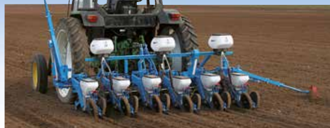
6 rij vast frame monobar MECA V4 zaaier met Microsem
