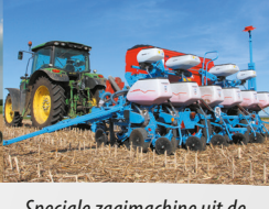
Speciale zaaimachine uit de Monosox NX M serie met schijven
