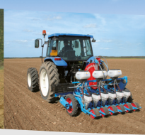
MS groentenzaaimachine voor zeer fijne zaden
