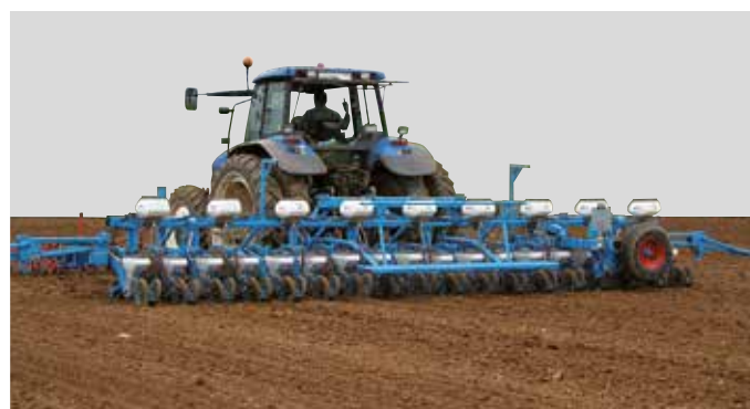
18 rij vast frame MECA V4 zaaier met Microsem en transportstel
