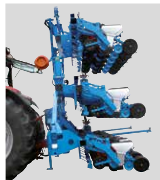
18 rij drie niveaus opklapbaar MECA V4 zaaier op transport
