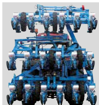
18 rij drie niveaus opklapbaar MECA V4 zaaier op transport
