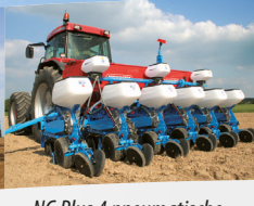
NG Plus 4 pneumatische zaaimachine met schijven
