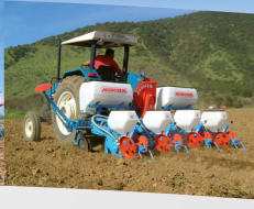
NC multifunctionele pneumatische zaaimachine met scharen
