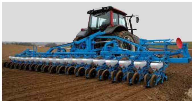
18 rij drie niveaus opklapbaar MECA V4 zaaier
