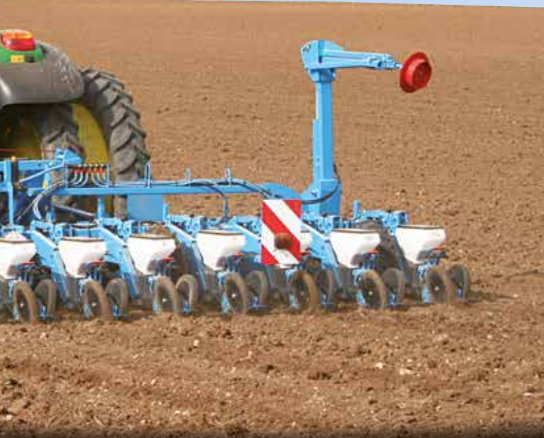
12 rij opklapbaar dubbel frame MECA V4 zaaier
