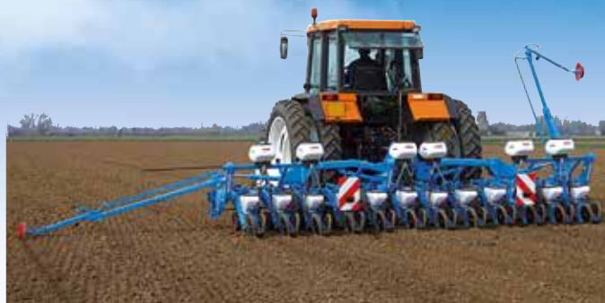
12 rij opklapbaar compact frame MECA V4 zaaier
