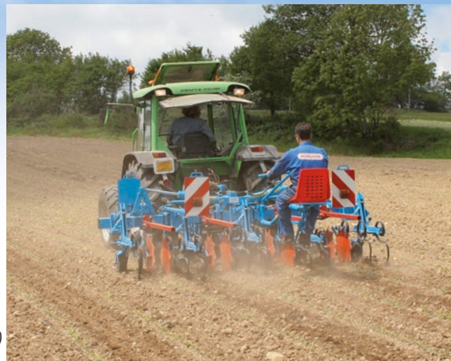
De stuurwielen (1) worden door de stuurstang (2) gestuurd en zijn in hoogte verstelbaar (3).
