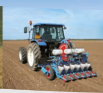
MS groentenzaaimachine voor zeer fijne zaden
