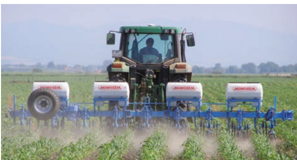
Vaste TIP 5" schoffelmachine aan het werk 8 rijen met 70 cm rijafstand
